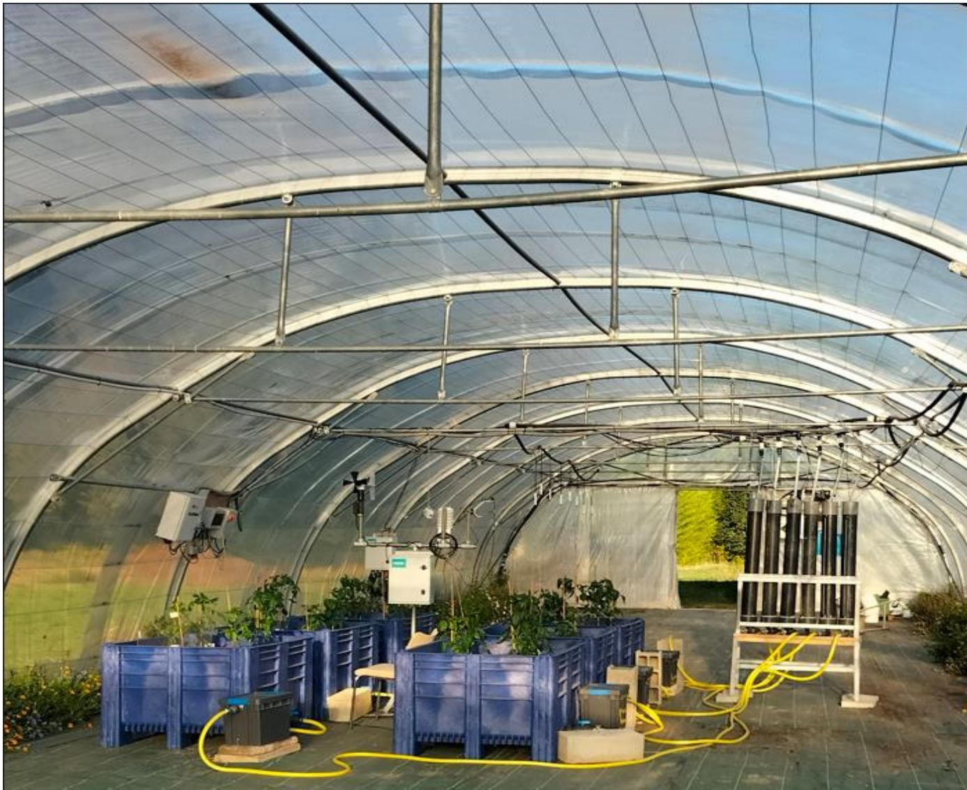
Colonnes d'alimentation en eau avec sondes de pression, bacs de terreau avec plants de piment, bacs à robinet flotteur, station météo
